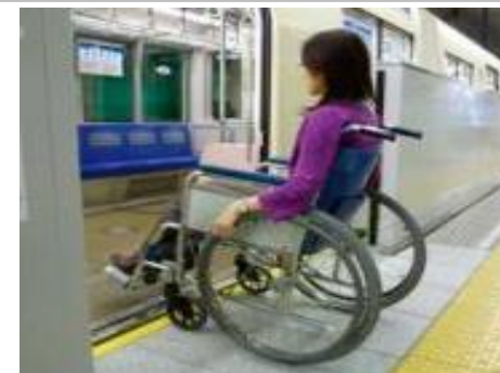
可動式ホーム柵／車両床面の隙間解消
