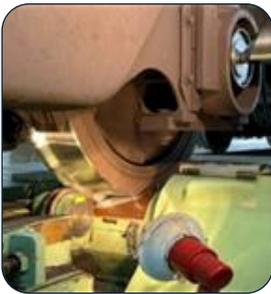
車両技術者は、安全走行に重要な役割を果たす車輪の定期的な形状の測定及び目視・触手点検のほか、車両走行時の「音」にも注意を傾け、車輪の状態を把握し、損傷の早期発見に努めています。車輪に関する問題が発生した場合は、他の保守部門と連携しながら問題の解決を図っています。
