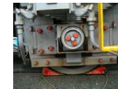
保守用作業車のハンドスコッチ設置状況
