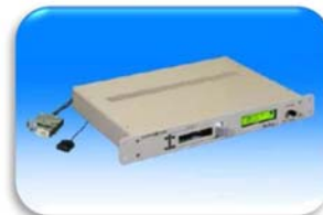
運転状況記録装置
