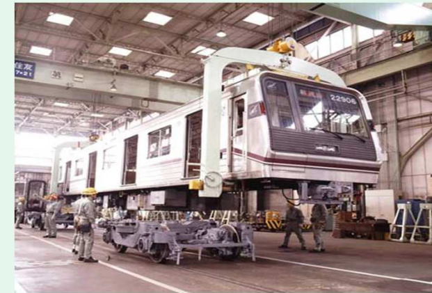
全般検査・重要部検査作業
