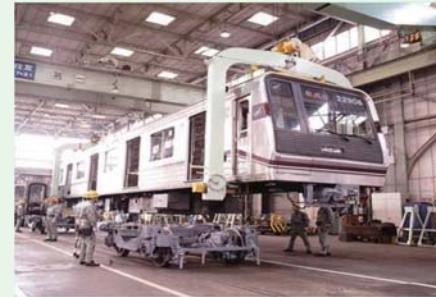
全般検査・重要部検査作業
