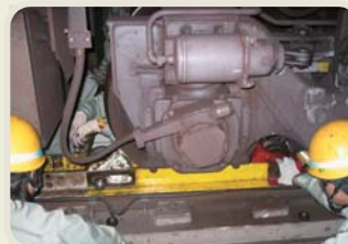
車軸不回転時に 取り付ける搬送台車
