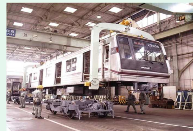
全般検査・重要部検査作業
