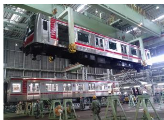
大規模な検査にともなう車体と台車の分離作業
