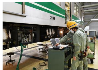
車体下の制御装置の整備
